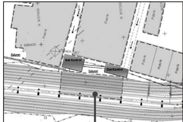
Gambar 10. Pembuatan Bak Kontrol dan Saluran Pembuang
