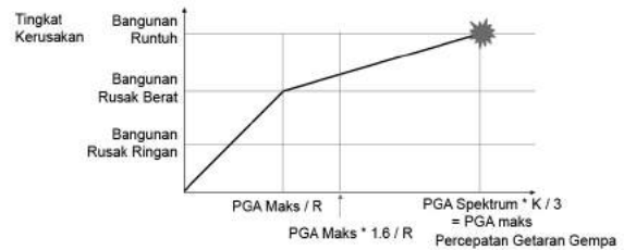
Gambar 12. Konsep Desain Bangunan Tahan Gempa Setelah Tahun 1981
